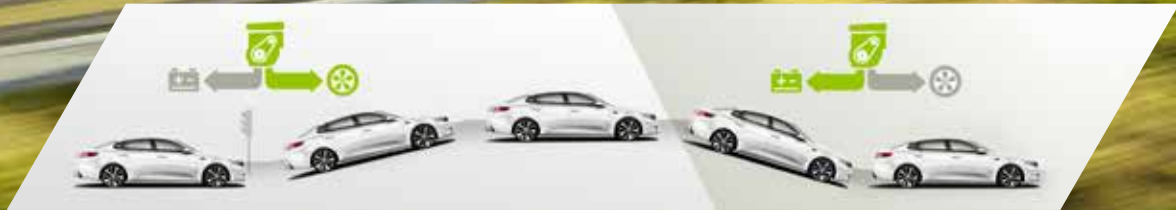
Sistema di frenata rigenerativa: l'energia cinetica prodotta durante la frenata o l'arresto viene recuperata e trasformata in energia elettrica per la ricarica della batteria.
