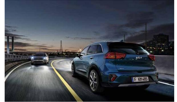
**Funzione antiabbagliamento automatica (HBA).** Di notte, le telecamere integrate nel parabrezza rilevano i veicoli in avvicinamento nella corsia opposta e comandano automaticamente il passaggio agli anabbaglianti per non infastidire gli altri guidatori. Una volta incrociato il veicolo, si riattivano gli abbaglianti.
