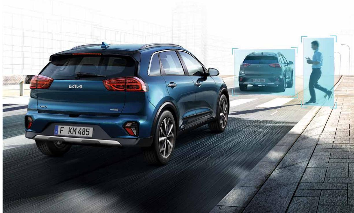
**Forward Collision Avoidance assist (FCA).** In base ai dati inviati dalla telecamera e dal radar, il sistema FCA è in grado di rilevare la presenza di veicoli, pedoni, ciclisti oppure ostacoli in rotta di collisione, di avvisarti e persino di applicare la massima forza frenante per fermare la vettura o ridurre al minimo i danni.
