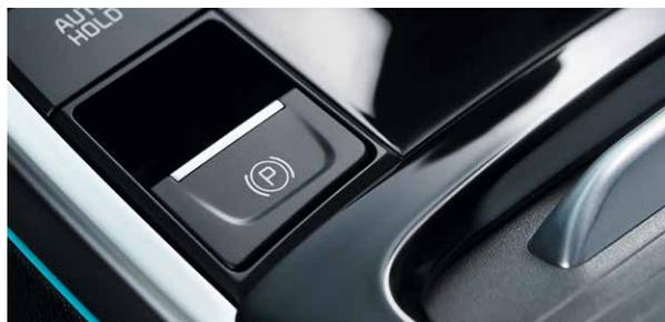
**Freno di stazionamento elettronico (EPB)** Puoi dire addio a leve o pedali: oggi ti basta premere un pulsante per attivare il freno di stazionamento.
