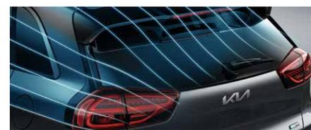
**Spoiler posteriore.** Sopra il lunotto è collocato uno spoiler che sfrutta il flusso dell'aria per stabilizzare il veicolo alle velocità sostenute.
