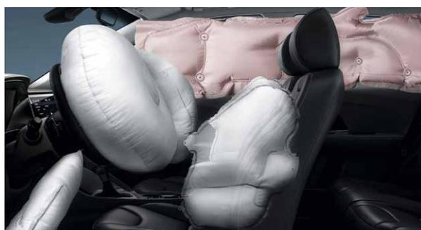
**7 airbag.** Studiate per limitare i traumi degli occupanti in caso di incidente, le dotazioni di serie di Kia Niro includono airbag frontali per guidatore e passeggero, due airbag laterali, due airbag a tendina e un airbag per le ginocchia lato guida.
