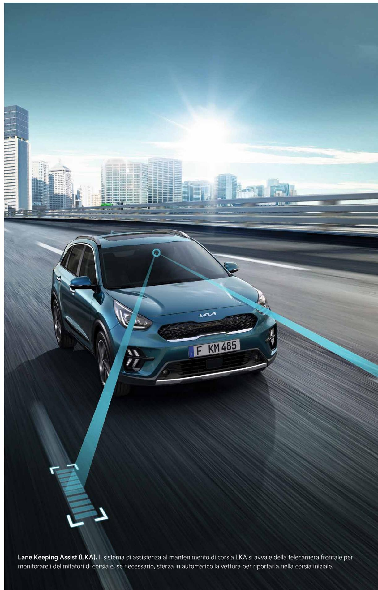
**Lane Keeping Assist (LKA).** Il sistema di assistenza al mantenimento di corsia LKA si avvale della telecamera frontale per monitorare i delimitatori di corsia e, se necessario, sterza in automatico la vettura per riportarla nella corsia iniziale.
