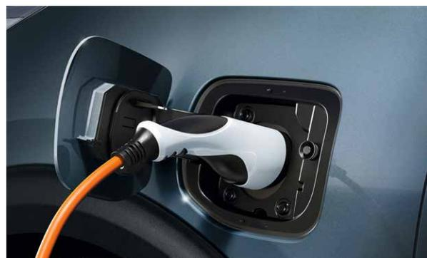
**Sportello di ricarica.** La batteria si ricarica in tutta praticità attraverso una presa domestica da 220 V o presso una stazione di ricarica pubblica. Per ricaricare completamente la batteria di Nuova Kia Niro Plug-in Hybrid presso una colonnina pubblica (240 V, 16 A), servono circa 2 ore e 15 minuti.
