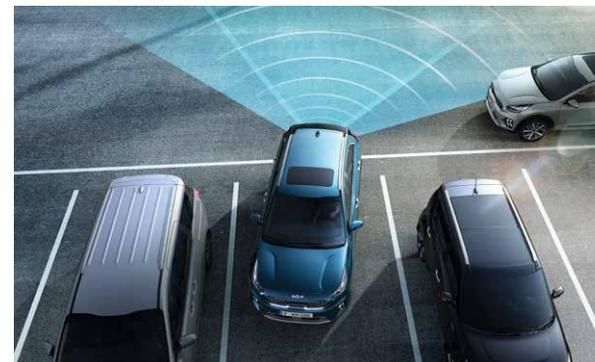
**Rear Cross Collision Avoidance Warning (RCCW).** Quando si esce in retromarcia da un parcheggio o da un vialetto, il sistema rileva e segnala la presenza di altri veicoli lungo la traiettoria.
