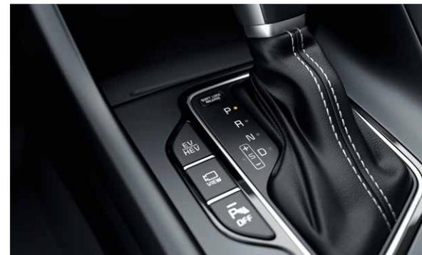
**Pulsante HEV/EV.** Il pulsante HEV/EV sulla console centrale ti permette di scegliere tra propulsione ibrida o elettrica. In modalità EV, ideale per la città, Niro Plug-in Hybrid sfrutta l'energia elettrica per una guida a emissioni zero.\* In modalità HEV, usa la doppia alimentazione, passando dal motore endotermico all'elettrico, oppure attivandoli entrambi, in base alla situazione.
