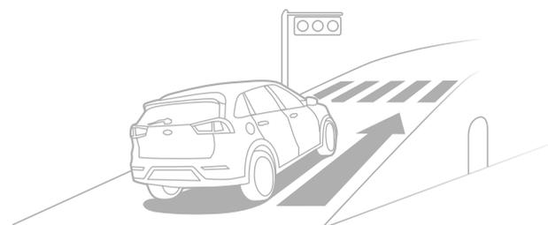
**Assistenza partenza in salita (HAC).** Nelle partenze in salita, il sistema di assistenza partenza in salita (HAC) impedisce l'arretramento della vettura, tenendo applicato il freno per un massimo di due secondi per darti il modo di spostare il piede sul pedale dell'acceleratore.
