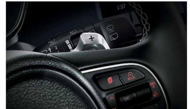
**Paddle a doppia funzionalità.** I paddle al volante, dotati di doppia funzionalità, sono un'esclusiva di Niro Hybrid e Niro Plug-in Hybrid. In modalità Eco, servono a gestire la frenata rigenerativa. In modalità Sport, invece, consentono di cambiare marcia senza staccare le mani dal volante, esaltando il dinamismo e il piacere di guida.
