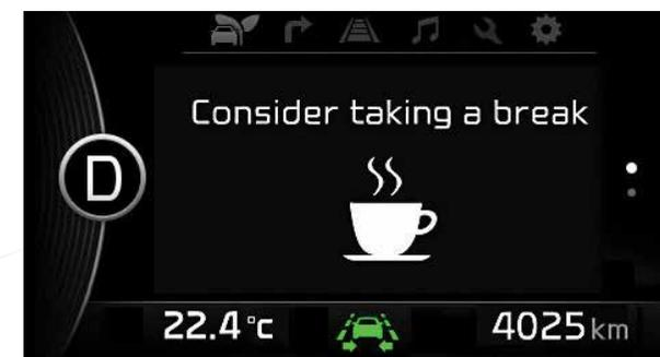
**Driver Attention Warning (DAW).** Il sistema riesce a rilevare un'eventuale perdita di concentrazione al volante monitorando i movimenti dello sterzo, gli indicatori di direzione e l'accelerazione. Se rileva segni di sonnolenza, emette un segnale acustico e visualizza un'icona a forma di tazza sul quadro strumenti, per invitare il guidatore a prendersi una pausa.
