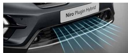
**Flap aerodinamico attivo.** Il flap aerodinamico attivo posto dietro la griglia anteriore si chiude alle velocità elevate per ridurre i consumi e migliorare le prestazioni, consentendo sempre il raffreddamento del motore.
