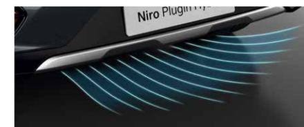
**Diffusore posteriore.** Al di sotto del paraurti posteriore è presente un diffusore, dotato di nervature longitudinali, che assicura stabilità e controllo aerodinamico alla vettura.
