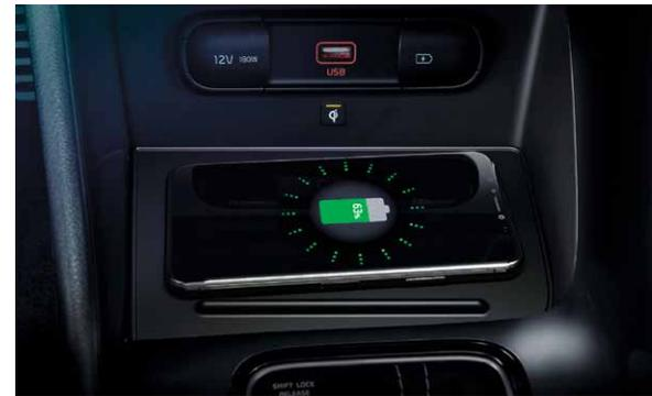
**Wireless Phone Charger.** Utilizza la base di ricarica wireless collocata di fronte al tunnel centrale per ricaricare il tuo smartphone compatibile, senza bisogno di cavi. Lo stato di avanzamento della ricarica viene segnalato da una spia luminosa.
